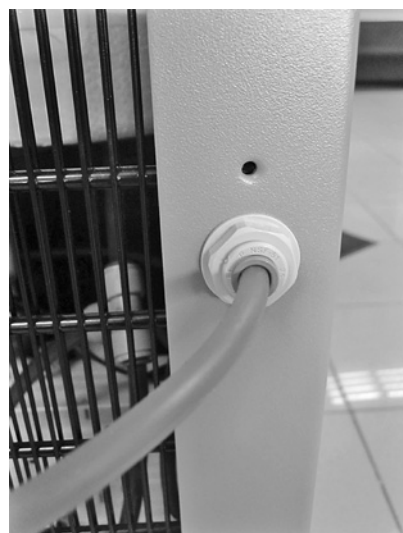
Рис. 5. Трубка для подключения к системе внутреннего водопровода
